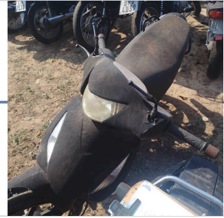
CARENAGEM DO PAINEL: ⚠️ AVARIADO
