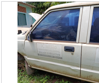
Porta Dianteira Esquerda: Avariado Observação: AMASSADA
