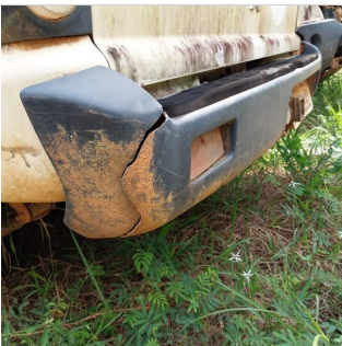
Parachoque Traseiro: 🚫 Avariado
