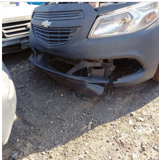
Parachoque Dianteiro: 🚫 Avariado
