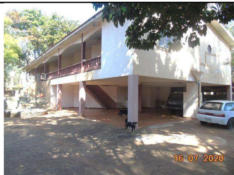
Casa com paredes de alvenaria de tijolos cerâmicos, forro de laje de concreto pré-moldada com blocos cerâmicos, piso de material cerâmico e/ou madeira, cobertura de telhas cerâmicas tipo romana, esquadrias metálicas e/ou de madeira, pintura látex e/ou esmalte sintético, sendo: - Subsolo: abrigo de veículos e 2 aptos., àrea= 188,00m<sup>2</sup>; - Pavimento Térreo: varanda, 7 aptos., 2 salas, cozinha, Área= 318,00m<sup>2</sup>;
