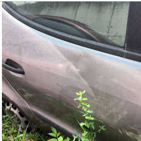
Porta Traseira Direita: Avariado
