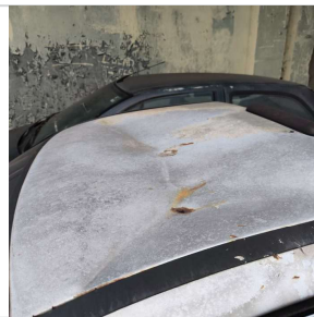
Teto: Avariado Observação:AMASSADO
