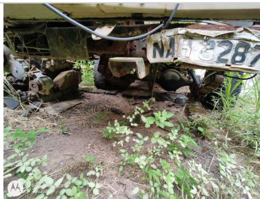
Paracheque Traseiro: Avariado
