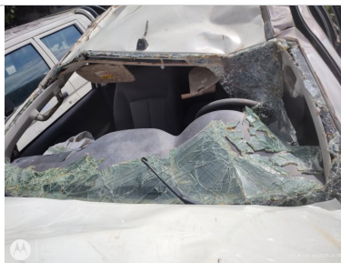
Parabrisa Dianteiro: Avariado
