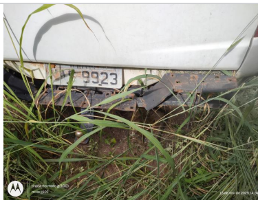
Paracheque Traseiro: Avariado
