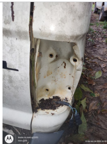
Lanterna Traseira Direita: ⊘ Avariado
