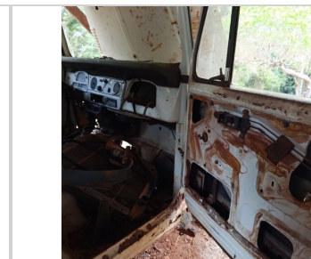
Forração Interna: ⚠ Faltando
