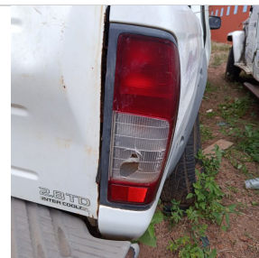
Lanterna Traseira Direita: ⊘ Avariado
