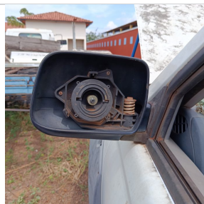
Retrovisor Lado Esquerdo: ⊘ Avariado
