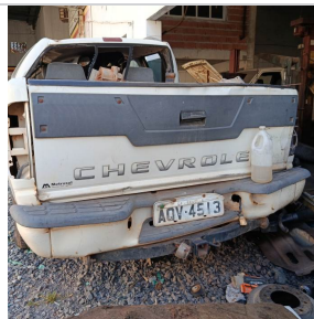
Paracheque Traseiro: Avariado Observação: AMASSADO
