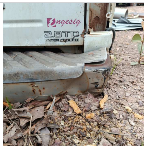
Paracheque Traseiro: Avariado
