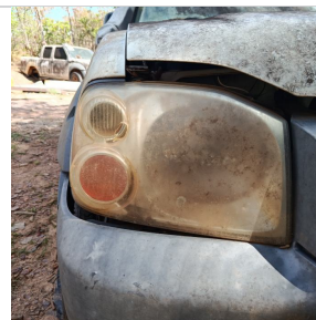
Farol Direito: Avariado Observação:LENTE QUEBRADA
