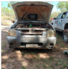
Paracheque Dianteiro: Avariado Observação:AMASSADO
