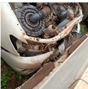
Parachoque Dianteiro: Avariado
