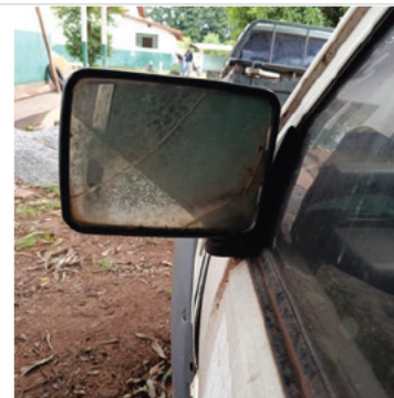
Retrovisor Lado Esquerdo: Avariado Observação: QUEBRADO
