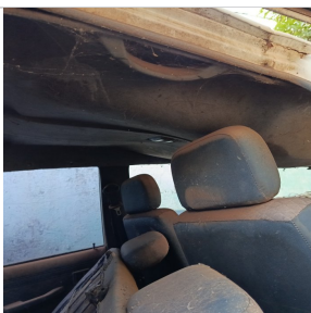
Forração Do Teto: ❌ Avariado
