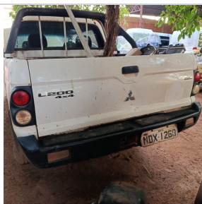
Paracheque Traseiro: Avariado Observação:AMASSADO
