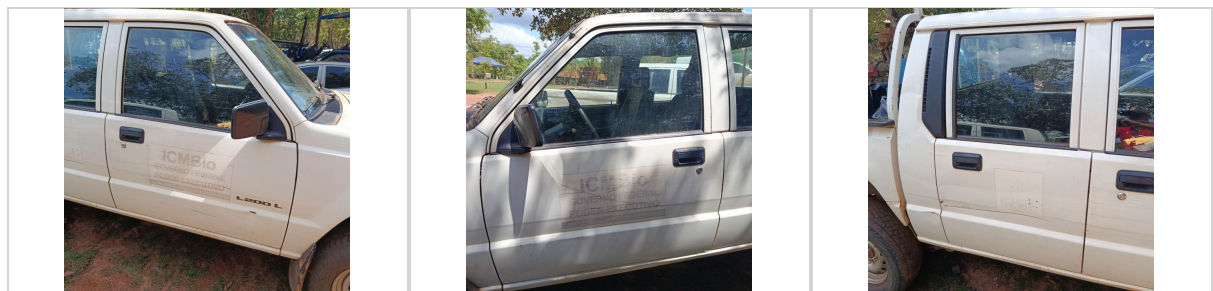
Porta Dianteira Direita: Avariado Observação:AMASSADOS
