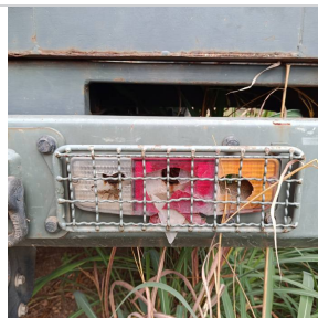
Lanterna Traseira Direita: ❌ Avariado
