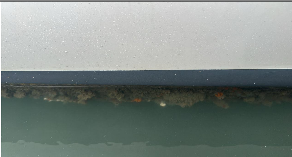
FIGURA 3: Incrustação excessiva no casco, vista de BB
