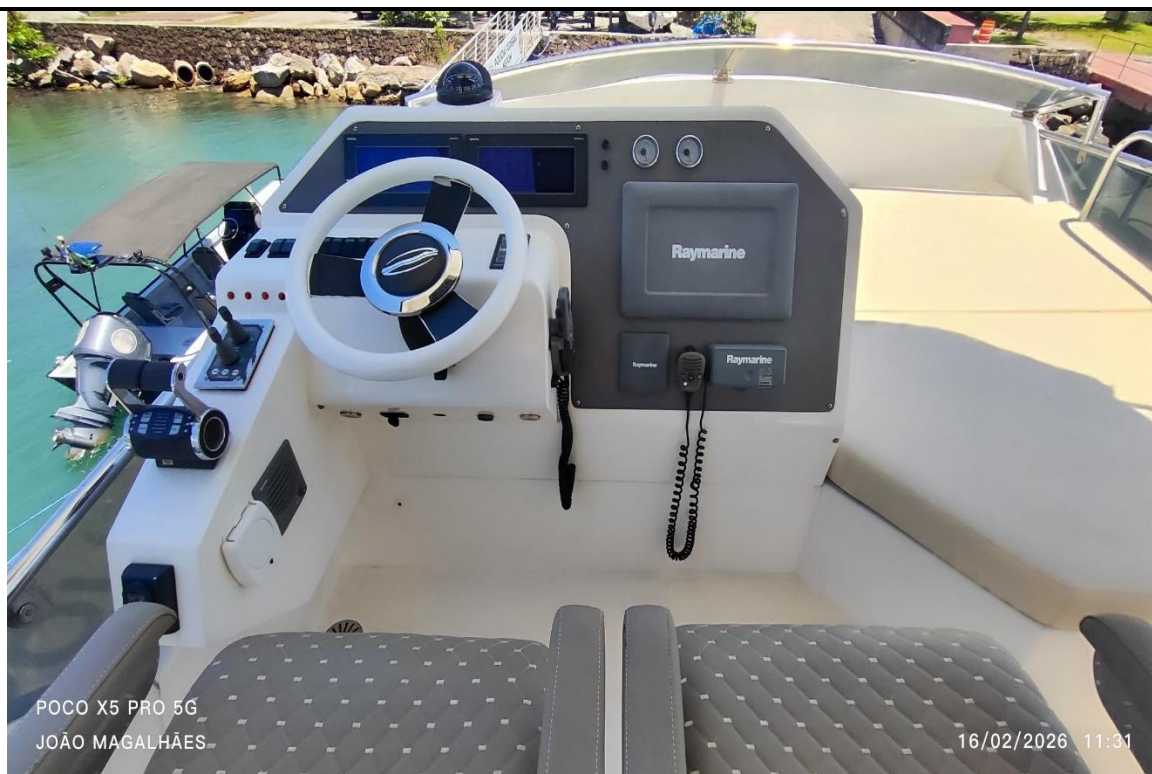
FIGURA 8: Equipamentos de controle e governo, e navegabilidade sendo testados, no painel do Flybridge.
