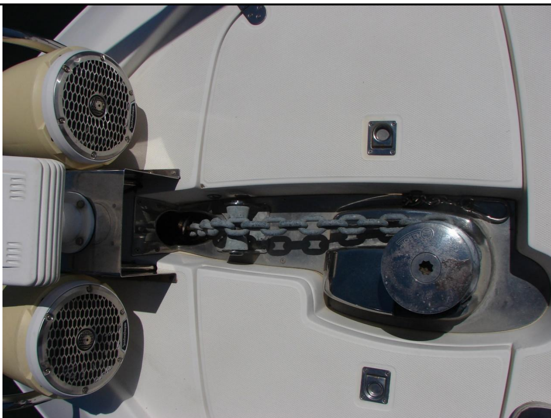
FIGURA 12: Guincho de âncora, inoperante durante a vistoria
