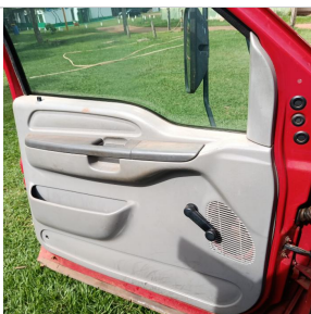
Forro da Porta D.E:
