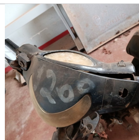
CARENAGEM DO PAINEL: AVARIADO
