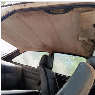
Forração Do Teto: ✗ Avariado
