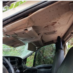
Forro de Teto: ✓ Ok Observação: AVARIADO
