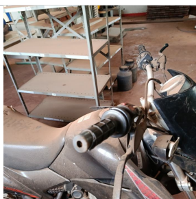
LUVA DO GUIDÃO: ⚠ AVARIADO
