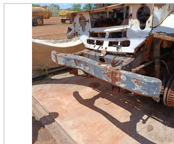
Paracheque Dianteiro: Avariado Observação:AMASSADO
