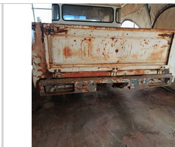
Paracheque Traseiro: Avariado Observação:AMASSADO
